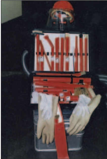
Obr. 2: Čisticí souprava pro napětí do 1000 V a osobní ochranné pomůcky
