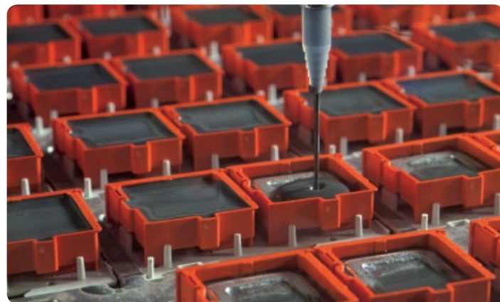
Zalévání varistoru v modulu DEHNguard
